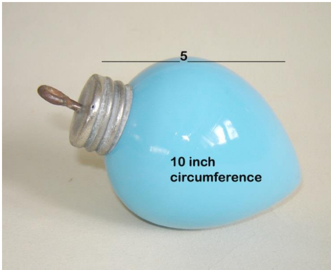
Blaues-Glas-Senklot aus CAN mit Blei gefüllt
