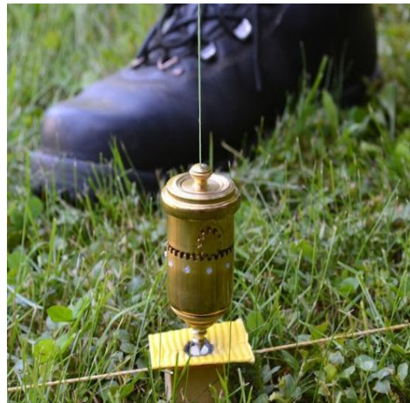
Das Getriebe-Lot im Einsatz
