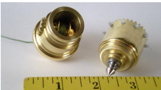
Innere Spule auf einer federgespannten Getriebeachse
