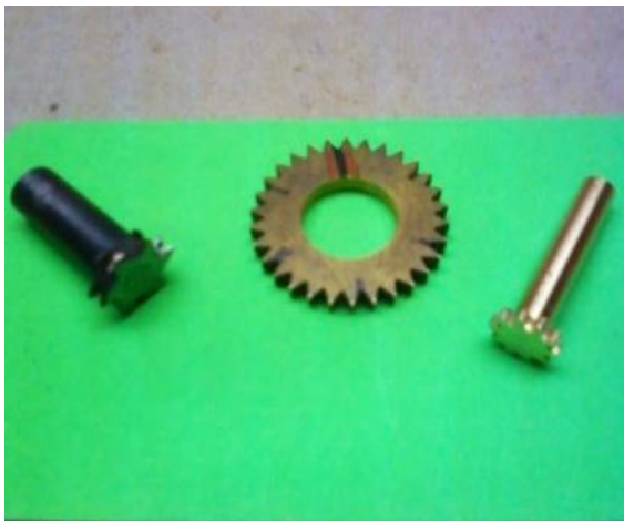
Selbst hergestellte Teile (v.l.n.r.) Zahnformfräser; 30-zähliger Teilungsindex; fertiges Zahnrad auf der Welle
