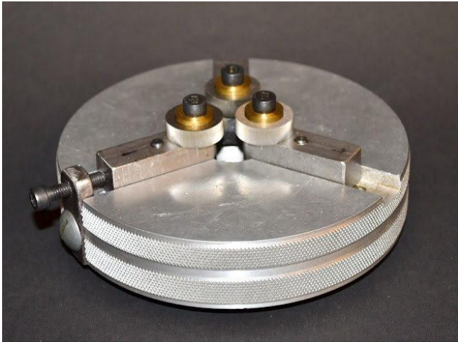
Reitstock montierte Rändelvorrichtung mit 3 Stahl-Werkzeugen. Damit kann man kleinste Durchmesser rändeln, ohne dass sie zur Seite gedrückt werden, wie es bei 1- oder 2-teiligen Werkzeugen der Fall ist.
