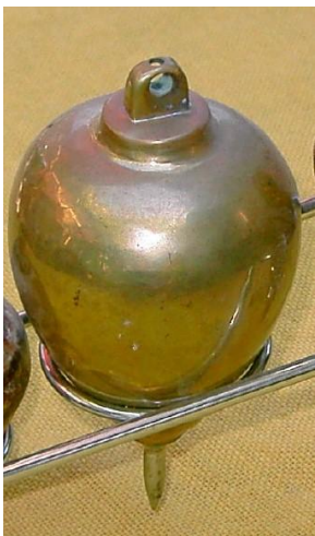
Bild links: Schweres Messinglot mit Stahlspitze
