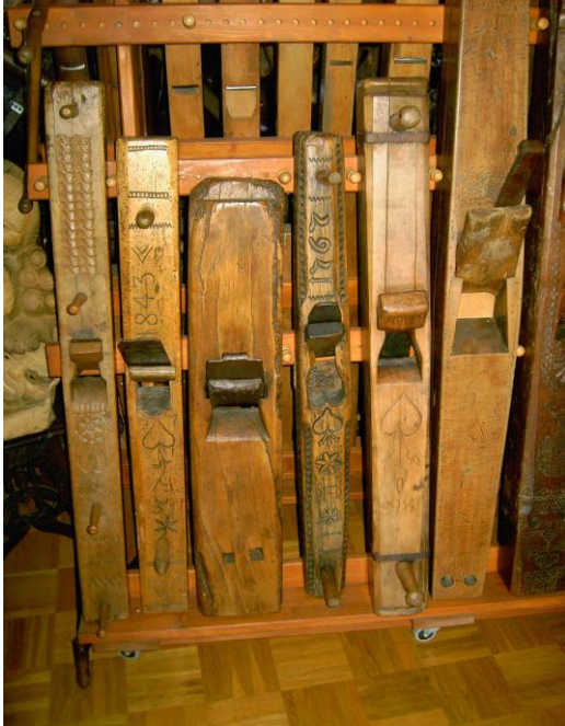
Diese Hobel (bis 1,30m lang) haben nicht in jeder Werkzeugkiste Platz. Zweimann-Hobel für Dielen und Küferhobel
