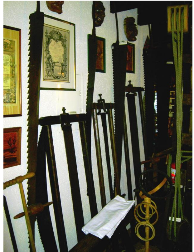
Rahmen- und Kransägen jeder Länge. (bis ca. 2,50 m)
