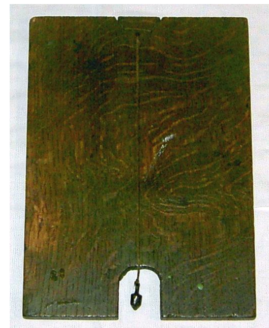
Setzwaagen aus Holz in verschiedenen Grundformen (A, T, Rechteck)
