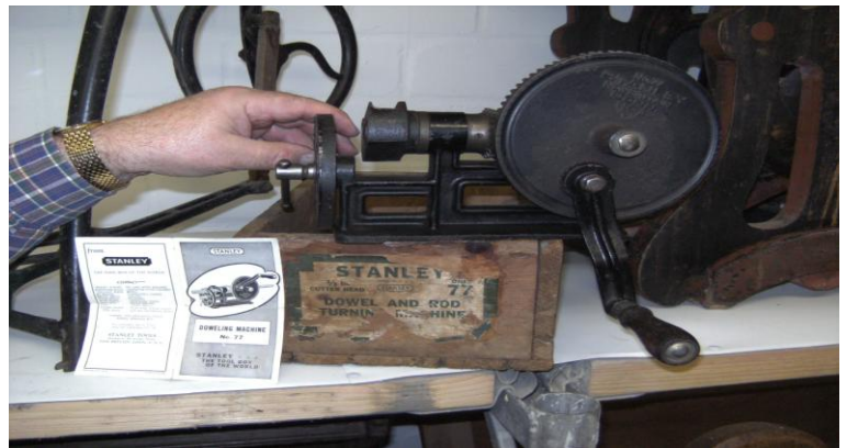
Natürlich gehören auch Holzbearbeitungsmaschinen dazu, wie dieses Gerät #77 von Stanley Rule & Level Co. (1911 bis 1969 fabriziert). Hiermit wurden aus rechteckigen Holzstäben runde Holzdübel von beliebiger Länge hergestellt
