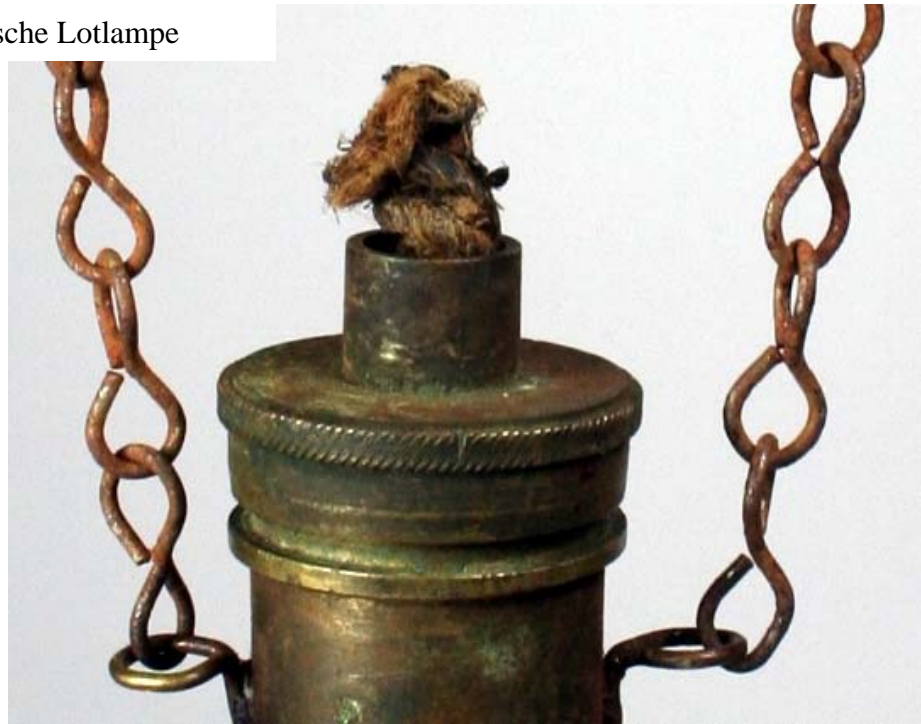
Sammlung Riccardo Chetoni. OHNE Kardanaufhängung. Ösen horizontal. Ketten aus Eisen. Kein Schutzdach gegen tropfendes Wasser
