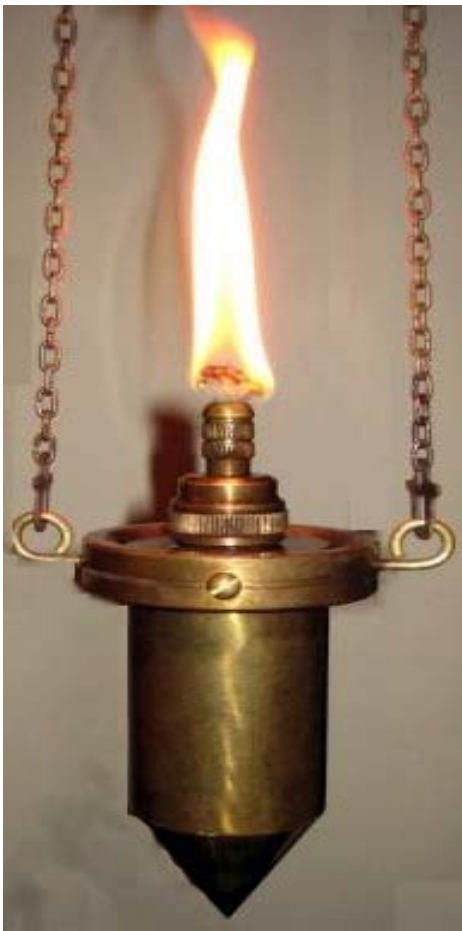
Brennende Lotlampe. Ösen senkrecht; mit Kardanaufhängung
