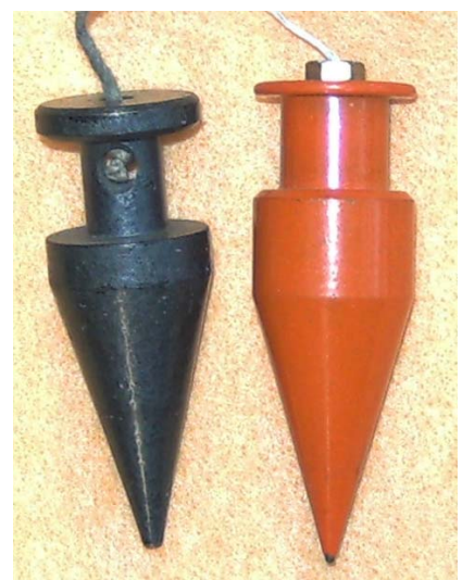
Bild 36 Lote, die bei Vermessungen unter dem Dreibein verwendet wurden
