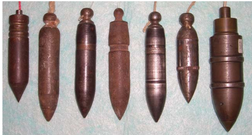
Bild 37. Lote aus Munitionsresten umgearbeitet
