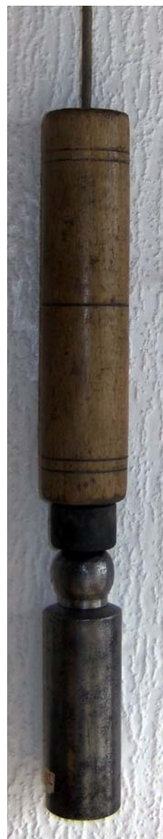
Bild 28. Runder Abstandshalter Holz, Gummidämpfer, Eisen Flachbodenlot
