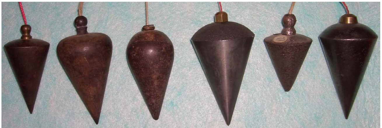
Bild 25. Deutschland unterschiedliche Schulterformen, Schraubenköpfe und Materialien
