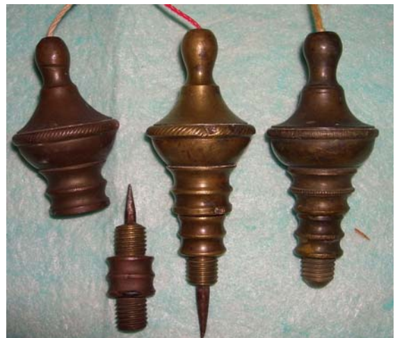
Bild 7 a: Typ 1913 mit umkehrbarer Spitze.
