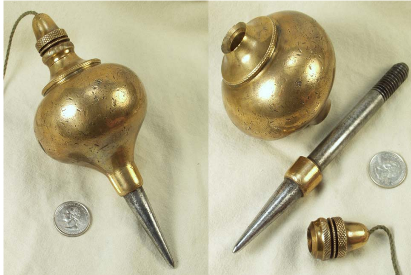
Bild 13. HEIMBACH umkehrbares Mühlenbauer Senklot
