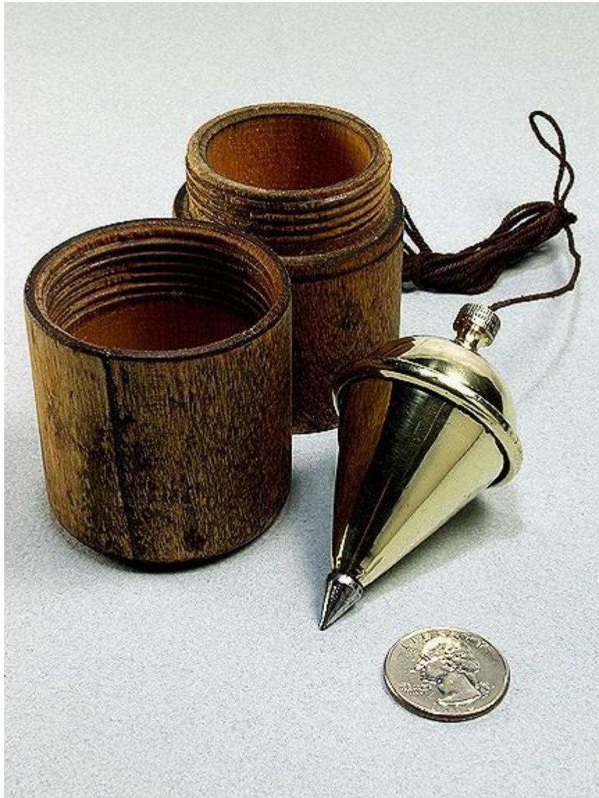
# 208. PERFECTION Senklot, patentiert 25. APRIL 1905, 3-1/8", 12-7/8 OZ. Verkauft in angepasster Holzdose. Hergestellt von TOWER & LYON, NEW YORK
